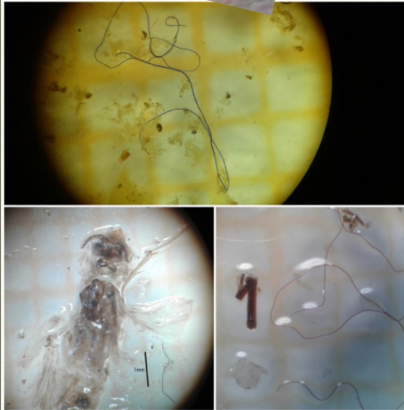
Figura 2. Filamentos de micro y meso plástico observados bajo lupa binocular (20 X y 40 X aumentos), escala de representación 1 mm
