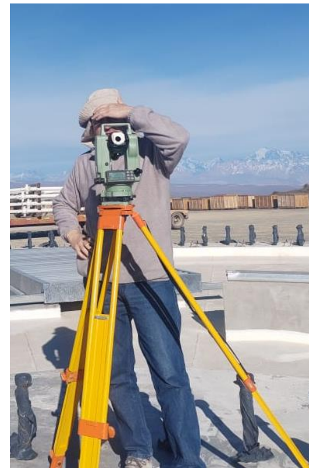
Teodolito Óptico STONEX (precisión 5 segundo)
