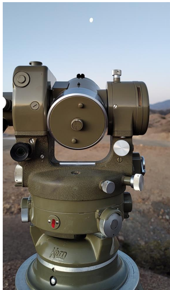
Teodolito Astronómico KERN DKM3 (precisión décima de segundo)
